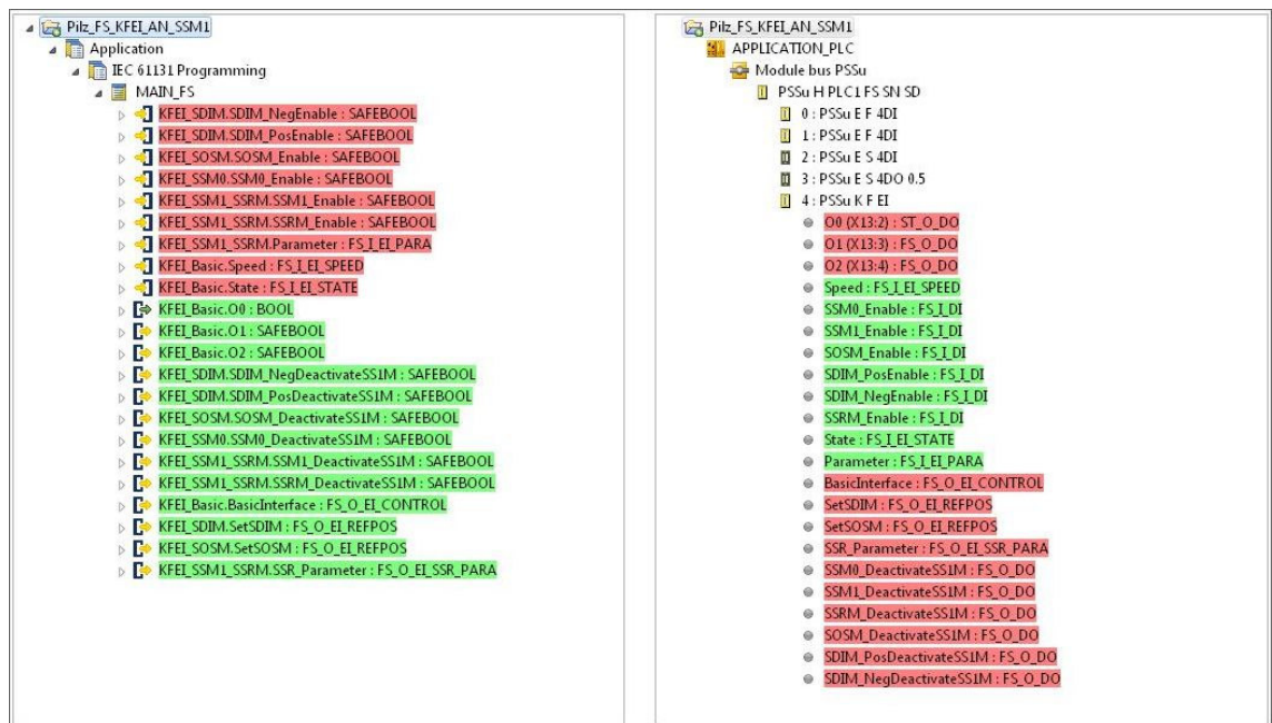
Fig. 14: I/O mappings of the module PSSu K F EI
