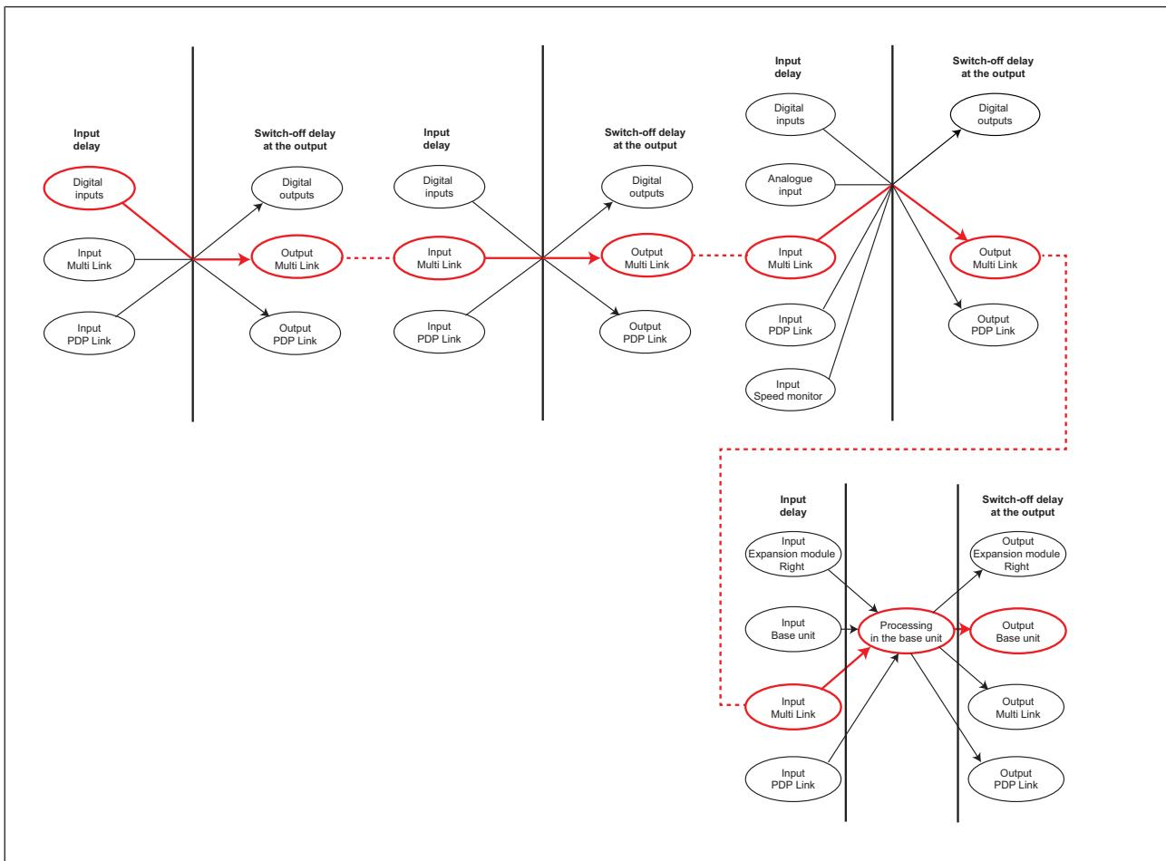
$$t_{\text{ReactionMax}} = 4 \text{ ms} + 35 \text{ ms} + 0 \text{ ms} + 35 \text{ ms} + 0 \text{ ms} + 35 \text{ ms} + 0 \text{ ms} 30 \text{ ms} + 1 \text{ ms}$$
