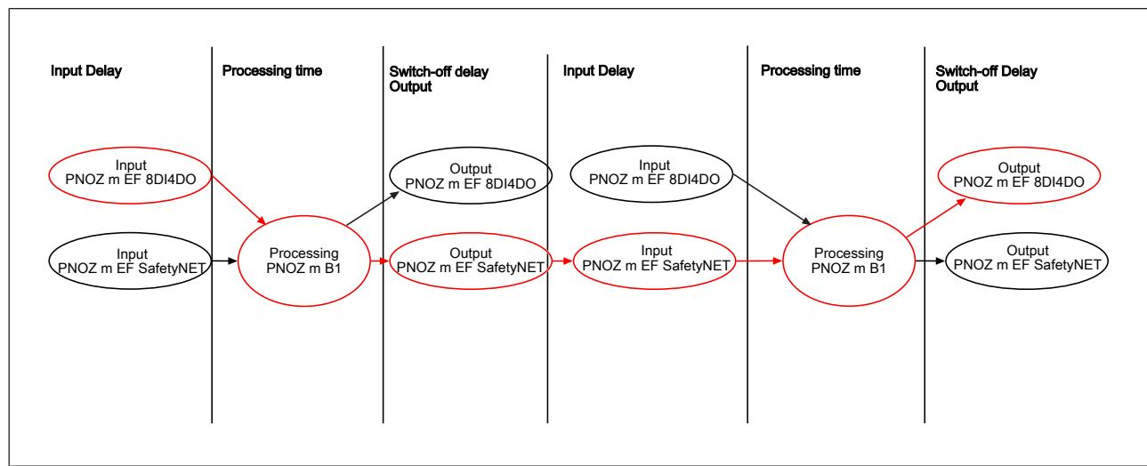
$$t_{\text{ReactionMax}} = 8 \text{ ms} + 30 \text{ ms} + 25 \text{ ms} + 0 \text{ ms} + 30 \text{ ms} + 3 \text{ ms}$$
