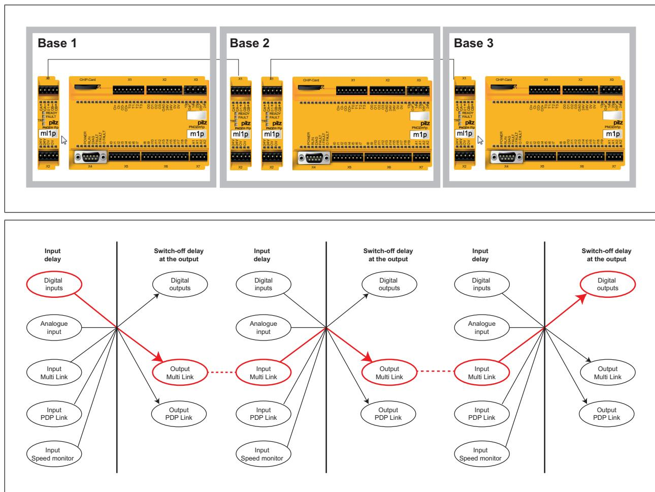
$$t_{\text{ReactionMax}} = 4 \text{ ms} + 35 \text{ ms} + 0 \text{ ms} + 35 \text{ ms} + 0 \text{ ms} + 30 \text{ ms}$$
