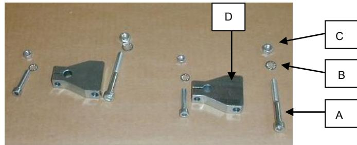
Verwenden Sie die mitgelieferten Schrauben (A), die Unterlegscheiben (B) und die Muttern (C) um die Montagebügel (D), wie in der Abbildung, auf die Schiene vom Umlenkspiegel zu montieren.
