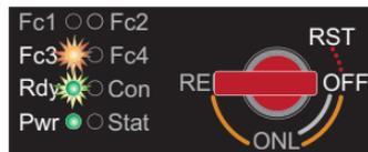
Wenn die beiden LED **Pwr** und **Rdy leuchten**, ist der Router auf seine „Werkseinstellungen bei Auslieferung“ zurückgesetzt und kann/muss neu konfiguriert werden.
